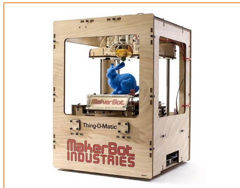
Рисунок 1. Дешевый, в сравнении с традиционными станками с ЧПУ, 3D принтер Thing-O-Matic компании MakerBot использует процессорную плату Arduino для управления шаговыми двигателями, печатающей термоголовкой и другими электромеханическими устройствами. Этот продукт превращает недорогой АБС-пластик в готовые объекты для создания прототипов или малотиражных изделий с допусками размеров 0.02 мм.
