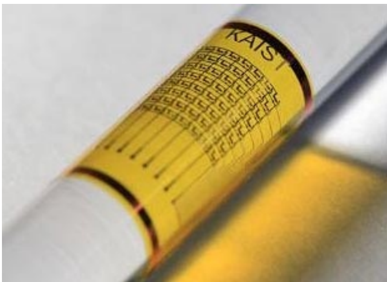
Гибкая память, намотанная на кварцевый стержень
