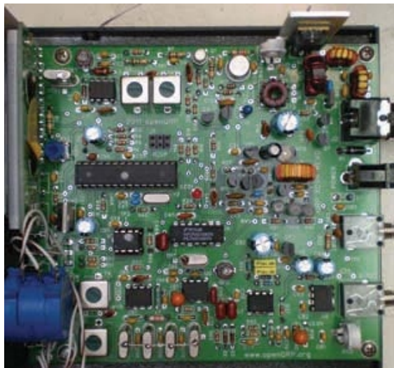
Рисунок 7. Этот дешевый маломощный CW-приемопередатчик сочетает в себе классическое аналоговое радио и программируемый интерфейс управления.
