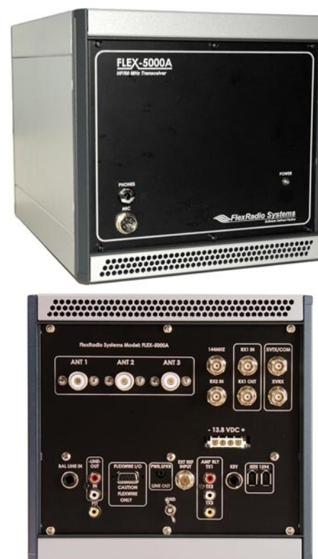
Рисунок 5. Flex-5000A компании FlexRadio Systems вообще не имеет передней панели управления.
