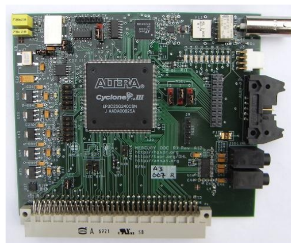
Рисунок 6. Модуль приемника Mercury, предназначенный для прямой дискретизации радиосигнала в полосе частот от 0 до 65 МГц.
