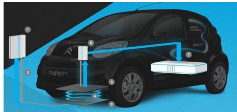
Конечной целью разработчиков Halo является создание системы динамической зарядки. Размещение индукционных катушек под существующей городской сетью позволило бы электробусам заряжать свои аккумуляторы беспроводным способом на ходу, двигаясь по маршруту, без необходимости остановки для перезарядки. По утверждению Qualcomm, динамическая зарядка выгодна и с точки зре-
