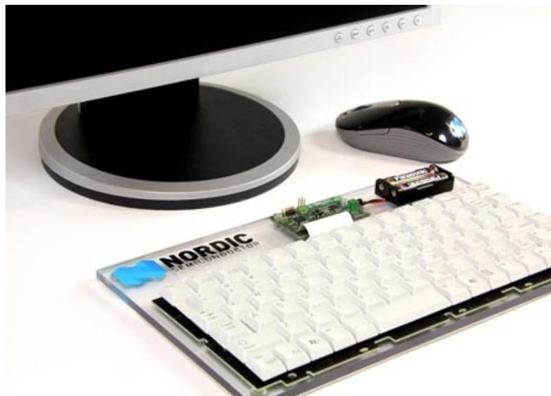
nRFready µBlue Desktop основана на малопотребляющей коммуникационной микросхеме µBlue nRF8001 фирмы Nordic, лидирующей в своем сегменте рынка. Платформа дает производителям беспроводной компьютерной периферии полный и проверенный набор аппаратных и программных средств, значительно снижающих риски ошибок при создании новых устройств, а также время и стои-
