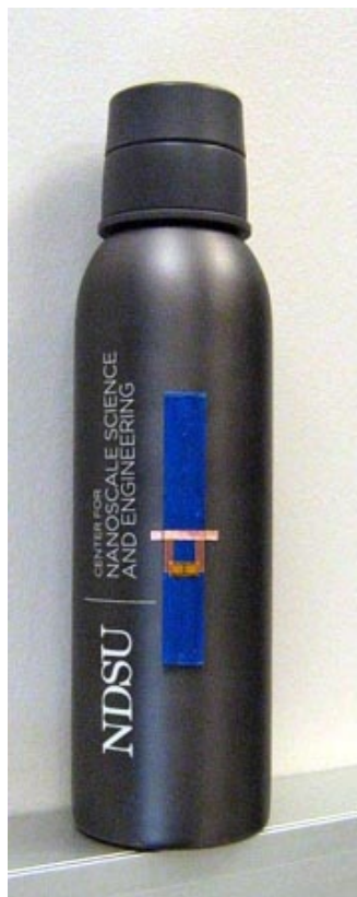
Одна из безантенных меток на металлическом баллоне.
