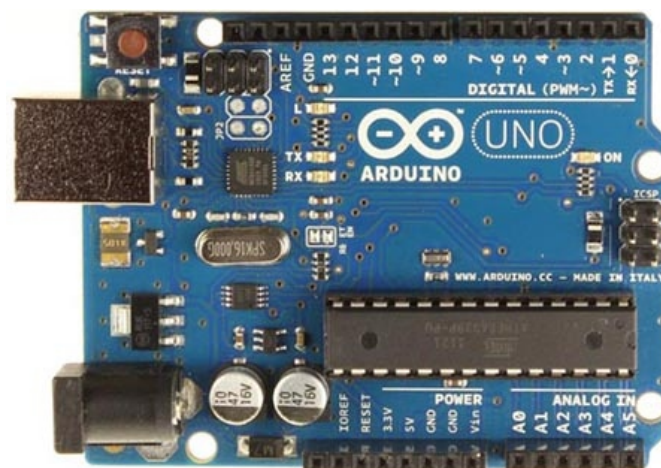
Рисунок 2. Аналоговые входы (A0 – A5) на плате Arduino Uno (rev3) и выходы ШИМ (цифровые выходы 3, 5, 6, 9, 10, 11) физически доступны через стандартные однорядные разъемы по краям платы.
