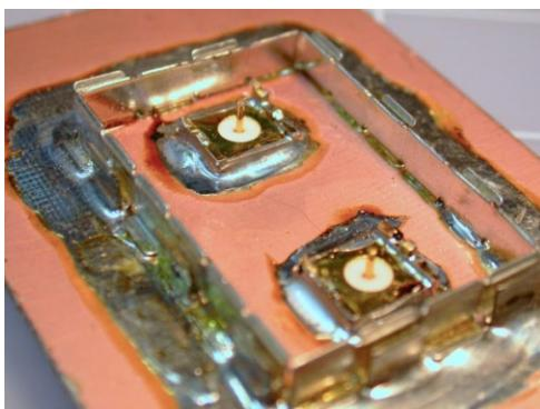
**Рисунок 1.** Чтобы проверить эту теорию, я припаял металлический экран размером 1.5 x 1.0 дюйма на кусочек стеклотекстолита. Для подключения входного и выходного сигналов я также припаял слегка модифицированные разъемы SMA, чтобы получить доступ к пространству внутри экрана. Разъемы действуют как маленькие емкостные зонды и позволяют нам получить количественную характеристику происходящего внутри экрана, подключив их к векторному анализатору цепей.
