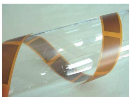
щими пленками. Таким образом, хрупкая пьезокерамика оказывается одновременно преднапряженной механически и изолированной электрически, что делает ее настолько прочной, что такие модули могут применяться на изогнутых поверхностях с радиусом искривления до 20 мм. «Пластырные» преобразователи приклеиваются на поверхность и могут использоваться для различных целей.
