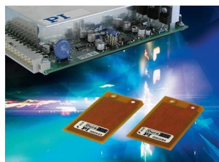
«Пластырные» преобразователи DuraAct представляют собой объединенные в эластичную композитно-полимерную структуру чрезвычайно компактные элементы, в основе которых лежит тонкая пьезокерамическая фольга, заключенная между двумя проводя-
