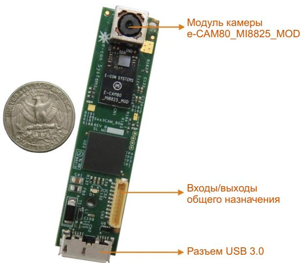
See3CAM\_80 идеально подходит для съемки документов, оптического распознавания изображений при съемке широкоформатных листов, медицинского и научного оборудования, применяемого при осмотре образцов ткани, оценке патологий и микроскопического анализа, где требуется потоковое видео высокого разрешения при низкой частоте смены кадров.
