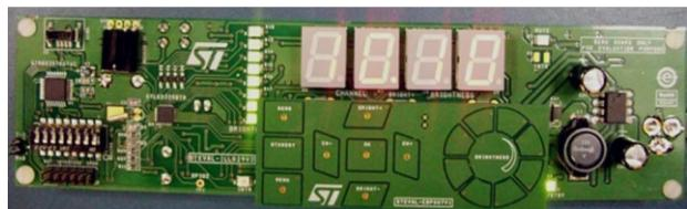
**Рисунок 5.** Оценочный набор STMicroelectronics представляет собой решение для лицевой панели управления на основе технологии S-Touch.
