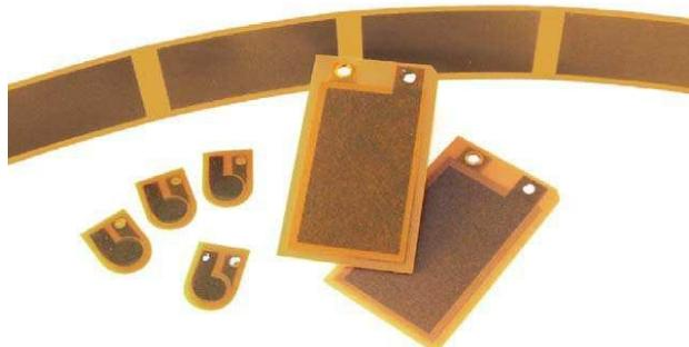
Стандартные «пластырные» преобразователи DuraAct состоят лишь из одного слоя пьезокерамики. Для специализированных приборов предусмотрена возможность изготовления многослойных устройств. В актуаторах увеличение числа слоев повышает генерируемую силу при одном и том же приложенном напряжении. При независимом подключении слоев можно одновременно использовать функционал и сенсора, и актуатора.
