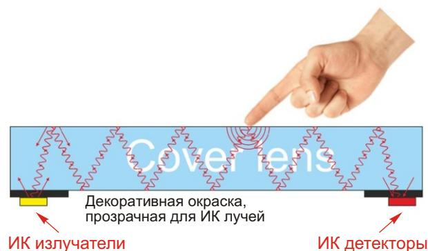
Любые другие известные сегодня решения, основанные на оптике, требуют наличия рамки по краю и не отвечают критериям Windows 8. Микросхема DA8901 поддерживает технологию FlatFrog, которая позволяет производителям получить гладкое решение без рамки, идентичное емкостной сенсорной панели. Однако, в отличие от емкостных устройств, в данном случае не используется никаких дорогостоящих слоев оксида индия и олова, которые отражали бы и преломляли
