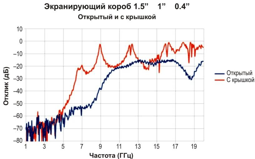
**Рисунок 4.** Синим цветом показана снятая с помощью ВАЦ зависимость между выходом и входом при снятой крышке экранирующего короба. Она отображает ожидаемое поведение емкостной связи вплоть до очень высоких частот. Красная кривая показывает, что происходит под закрытой крышкой, которая превращает нашу скучную печатную плату в высокорезонансную и сложную полуую структуру с несколькими резонансами.
