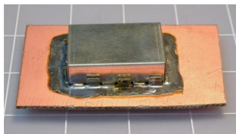
**Рисунок 3.** Внешний вид тестовой установки с установленным экраном.
