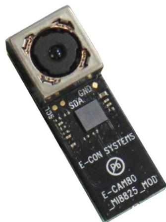
ческий формат 1/3.2", размер пикселя 1.4 мкм, интерфейс MIPI CSI-2, и поддерживает разрешения 720p60, 1080p60, а также 8 мегапикселей с частотой 24 кадра в секунду.
