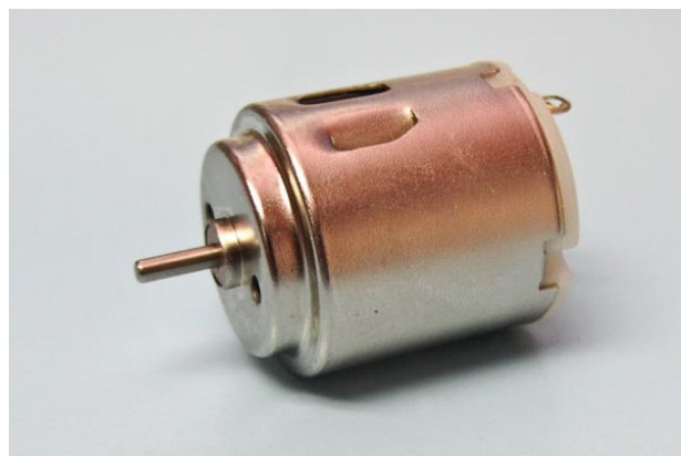
Рисунок 5. Электромотор постоянного тока, купленный у Radio Shack.
