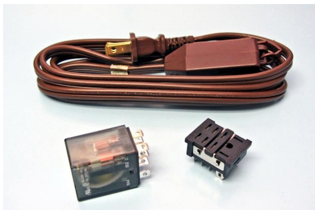
Рисунок 2. Компоненты, необходимые для самостоятельного изготовления устройства, основанного на дребезге контактов реле.
