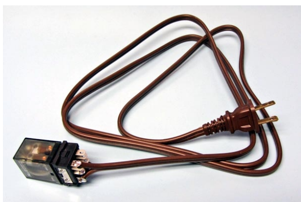
Рисунок 3. Схема, использующая дребезг реле, в собранном виде.
