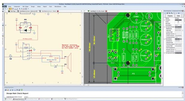
Мультидокументный интерфейс CADSTAR Essential позволяет отображать схемы и печатные платы в одной и той же пользовательской среде.
