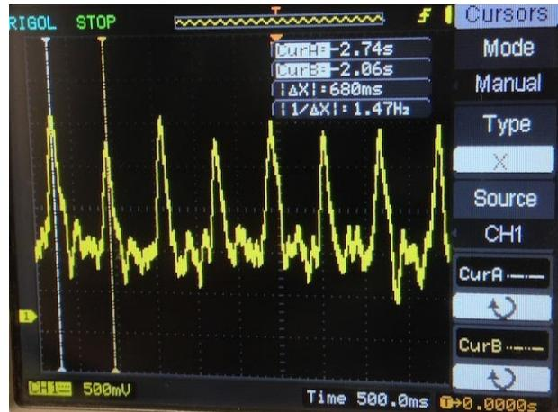
**Рисунок 3.** Форма сигнала в узле OUT.
