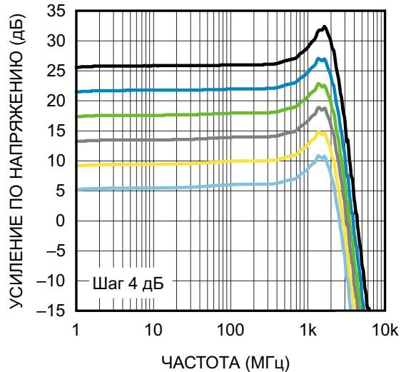
**Рисунок 2.** Семейство амплитудно-частотных характеристик PDA. Шаг приращения коэффициента усиления 4 дБ.
