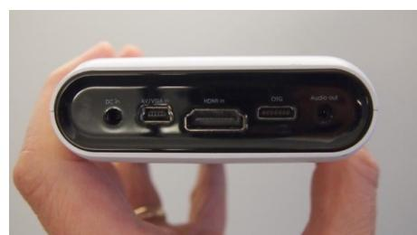
TouchPico имеет также HDMI и аудио порты. Его встроенный Wi-Fi может использоваться с программой ScreenCast для Android. Питается проектор от стандартного сетевого адаптера.
