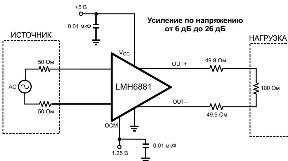
Рисунок 1. Типичная схема включения программируемого дифференциального усилителя.
