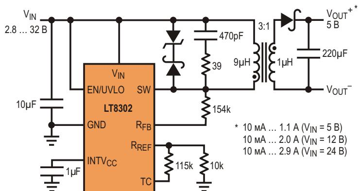
Рисунок 1. Законченный 5-вольтовый изолированный обратноходовой преобразователь для входных напряжений от 2.8 В до 32 В.
