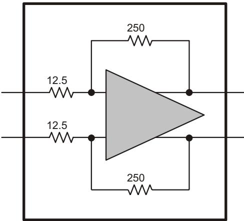
**Рисунок 5.** FDA с коэффициентом усиления 26 дБ.
