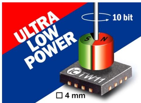
ток потребления прибора равен 3 мкА. В режиме покоя между циклами измерения ток падает примерно до 100 нА. В нормальном режиме работы при активированных фильтрах и включенной автоматической регулировке усиления iC-TW11 поддерживает частоту выборки 4 кГц с максимальным разрешением 10 бит. Управлять циклами измерения можно либо с помощью интерфейса SPI, либо сигналами от внешнего источника событий, подаваемыми на отдельный вход синхронизации.
