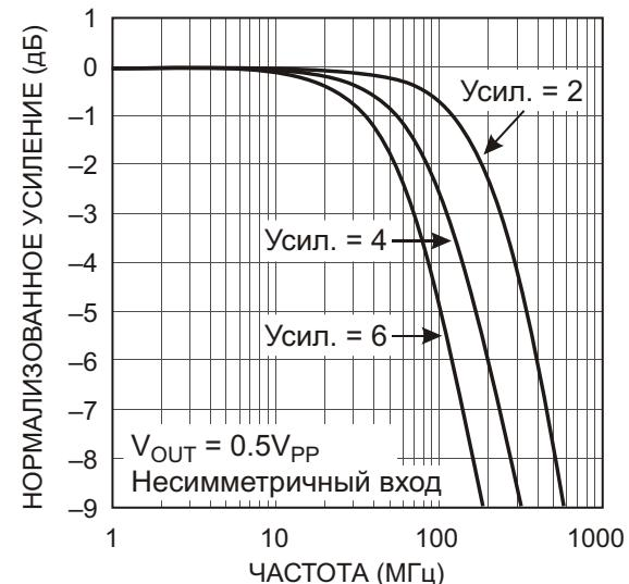
**Рисунок 3.** Амплитудно-частотная характеристика традиционного FDA.
