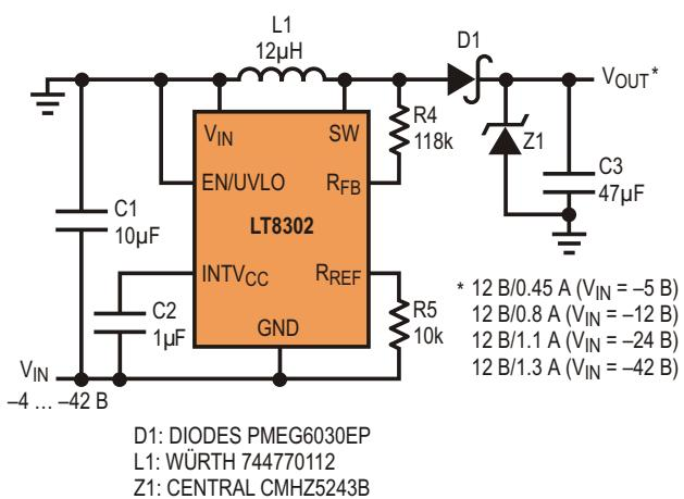
**Рисунок 3.** Повышающе-понижающий преобразователь отрицательного напряжения в положительное.
