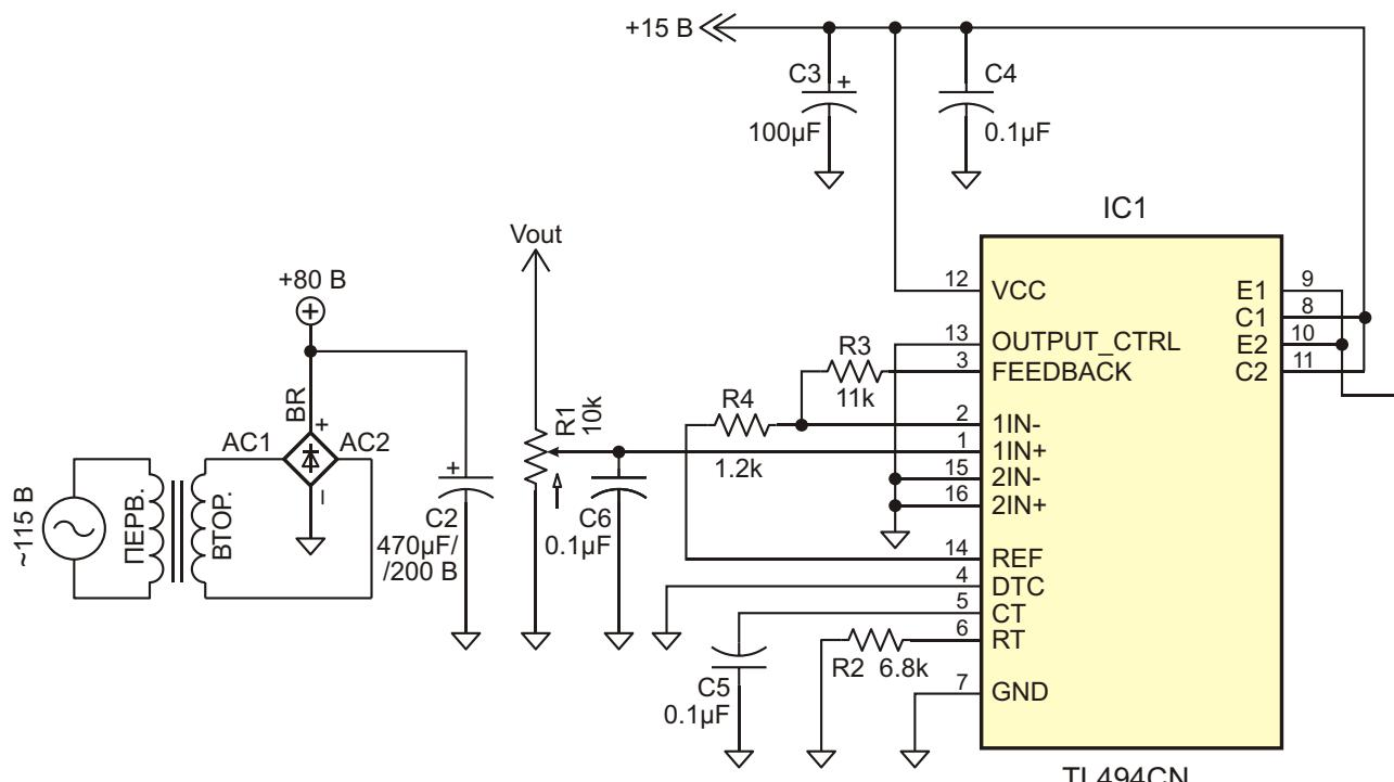
Рисунок 1. Принципиальная схема высоковольтного понижающего преобразователя напряжения.
