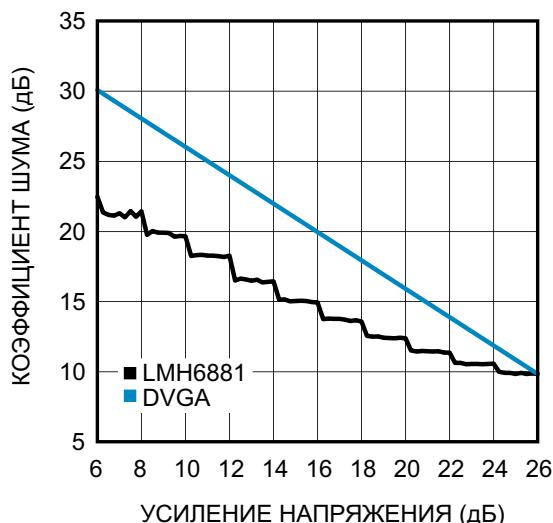
**Рисунок 6.** Сравнение коэффициентов шума PDA и традиционного DVGA.
