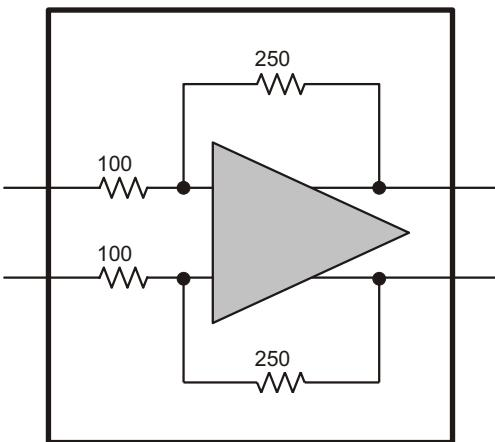
**Рисунок 4.** Обычный FDA с коэффициентом усиления 8 дБ.
