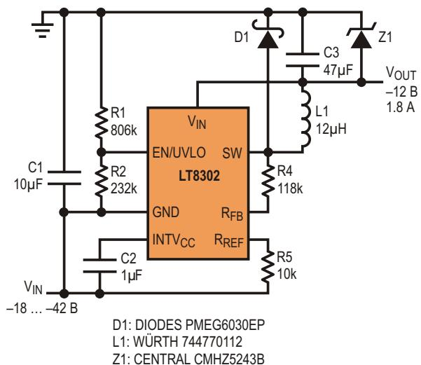
**Рисунок 4.** Понижающий преобразователь отрицательного напряжения в отрицательное.
