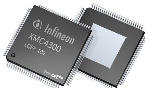
С помощью XMC4300 и XMC4800 появляется возможность реализации исключительно элегантных решений для построения смешанных сетей CAN и EtherCAT. Микросхемы позволяют создавать шлюзы CAN – EtherCAT, использующие эффективный обмен по каналам ПДП. XMC4300 содержат 256 КБ флеш-памяти и 128 КБ ОЗУ. Микроконтроллеры имеют два узла CAN с буфером FIFO для принимаемых и передаваемых сообщений, спо-
