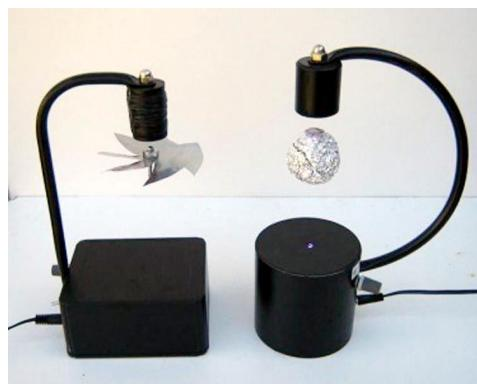
**Рисунок 11.** Интересным левитирующим объектом может стать небольшой пропеллер с магнитом, прикрепленным в его центре.
