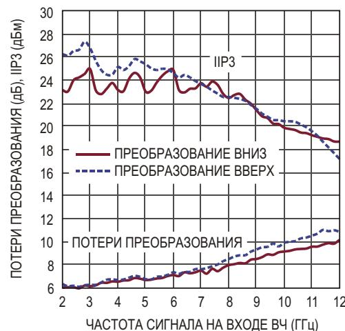
Зависимость потерь преобразования и IIP3 от частоты. (Преобразование вниз, промежуточная частота 240 МГц).
