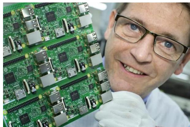
На плате Raspberry Pi 3 установлены 4 порта USB, аудио/видео выход 3.5 мм, разъем HDMI, 40-контактный разъем расширения и разъемы интерфейса подключения камеры. Для питания платы рекомендуется использовать внешний источник 5 В, способный отдавать выходной ток не менее 2.5 А (для Raspberry Pi 2 – не менее 1.8 А).
