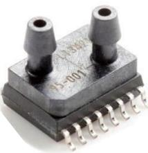
чение имеет величина ухода точности, обусловленная высокотемпературным старением (1% после работы в течение 1000 ч при повышенной температуре 150 °C). Это делает новый прибор одним из самых ста-
