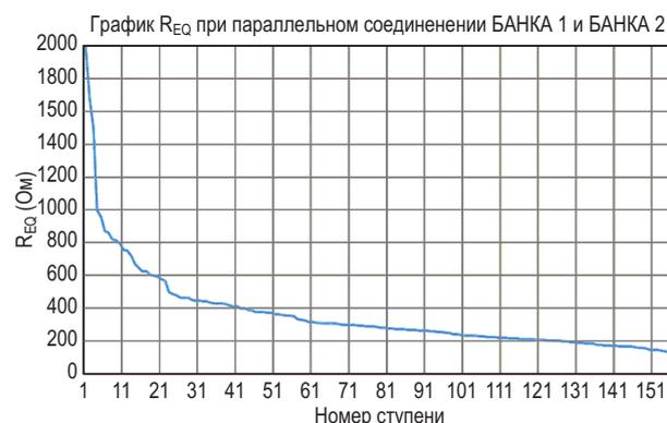
**Рисунок 5.** Зависимость  $R_{EQ}$  от номера ступени с резисторами  $R = 1000$  Ом в БАНКЕ 1 и  $R = 910$  Ом в БАНКЕ 2 (при замкнутом SS) с последовательностью ступеней, установленной для получения монотонно уменьшающихся значений сопротивления.
