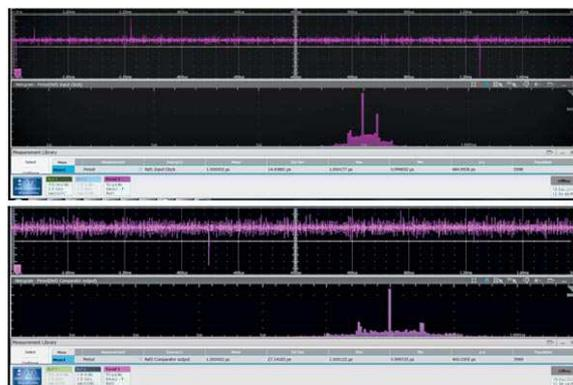
**Рисунок 4.** В объединенных результатах, полученных с помощью приложения Tektronix «TekScope Anywhere», верхняя диаграмма представляет собой входные тактовые импульсы вместе с их гистограммой (стандартное отклонение входного тактового сигнала составляет 14.4 пс), а нижний график показывает выходной сигнал компаратора и его гистограмму (стандартное отклонение выходного сигнала компаратора составляет 27.1 пс).
