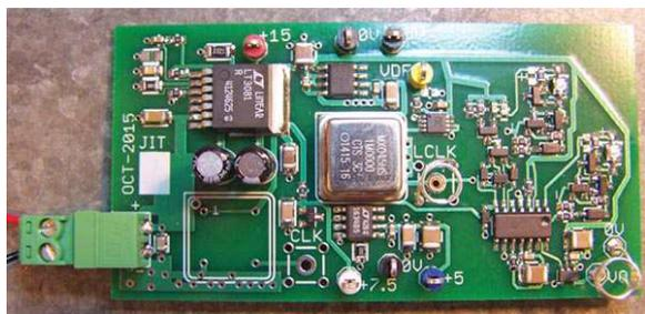
**Рисунок 1.** На печатной плате схемы, используемой для тестирования компаратора тактовыми импульсами с низким джиттером, двоякый компаратор находится в крайнем правом углу (один компаратор активен, второй «отвязан» как запасной), а модуль тактового генератора 1 МГц находится в центре платы.
