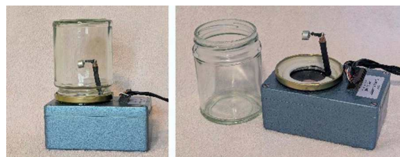
Рисунок 3. Два изображения испытательного стенда, позволяющего измерять частотную характеристику микрофона в субгерцовом диапазоне.
