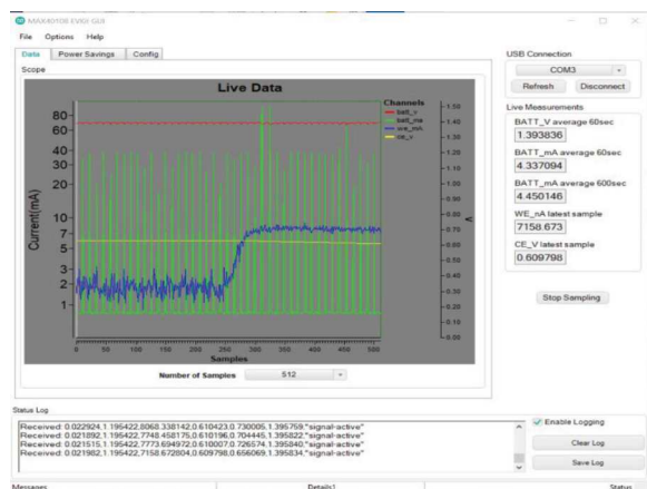
Рисунок 6. Характеристики датчика CO с микросхемой MAX40108.
