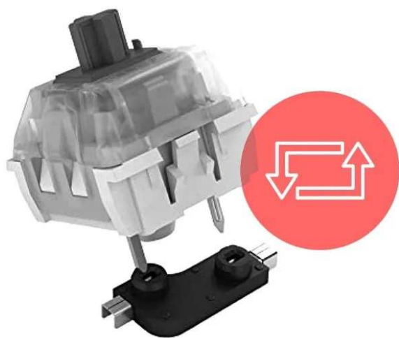
Рисунок 1. При горячей замене схема извлекается, а на ее место вставляется замена.
