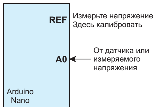
Рисунок 3. Этот код непрерывно считывает данные с АЦП, подключенного к аналоговому выводу A0. Если напряжение на выводе A0 меньше 1.1 В, опорное напряжение АЦП переключается на 1.1 В. Если напряжение на выводе A0 больше 1.1 В, опорное напряжение АЦП переключается на V_{CC} .
