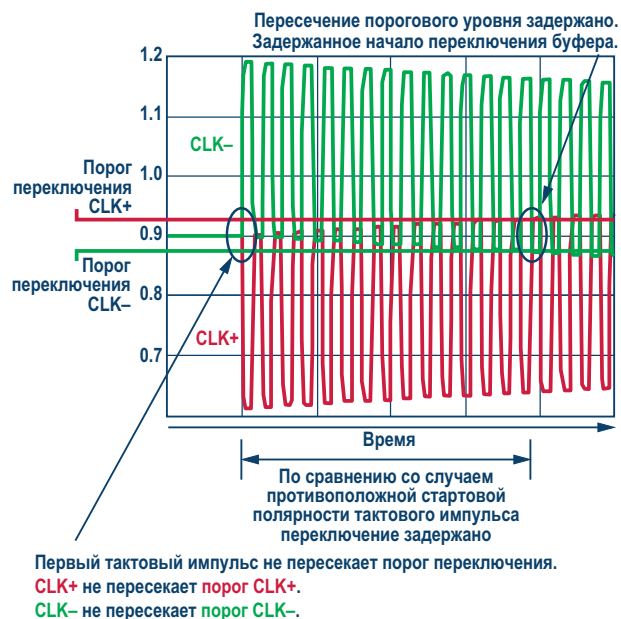
Рисунок 2. Запуск преобразования при спадающем фронте первого импульса CLK+ и нарастающем фронте импульса CLK–.
