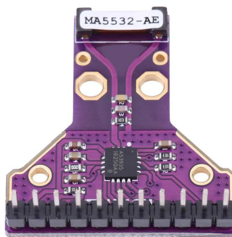
Рисунок 1. Модуль содержит микросхему датчика молний AMS AS3935 и антенну Coilcraft.
