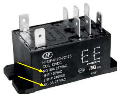
Рисунок 3. Большинство силовых реле рассчитаны на значительно более высокий ток нормально разомкнутых контактов по сравнению с нормально замкнутыми.
