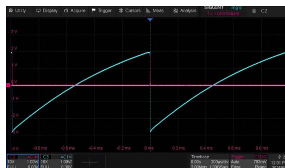
Рисунок 2. Формы сигналов простой схемы релаксационного генератора. Голубая осциллограмма снималась с закрытым входом, а пурпурная – с открытым.
