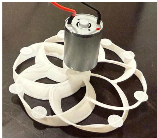
Рисунок 3. Ветряная микротурбина, состоящая из двигателя постоянного тока и ротора.
