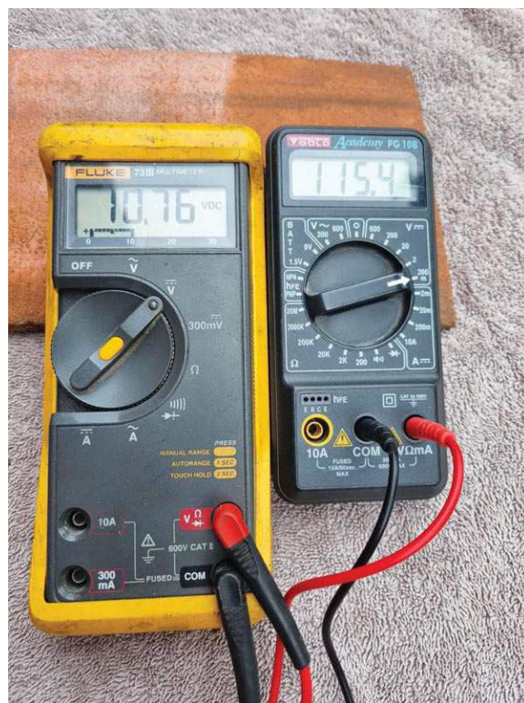
Рисунок 9. Напряжение на батарее и на выходе микросхемы LTC6102.
