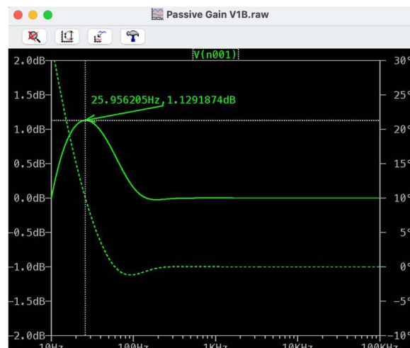
Рисунок 6. Реакция смоделированной пассивной RC-цепи точно соответствует диаграмме Бode, показанной на Рисунке 5.
