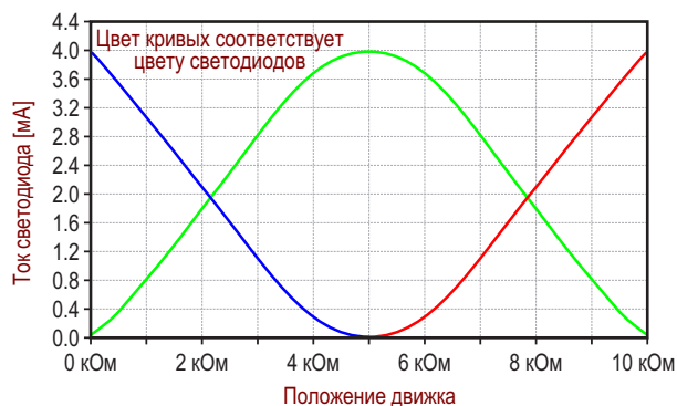
Рисунок 4. Характеристика переработанной конструкции более линейна, что обеспечивает более плавный спектр.
