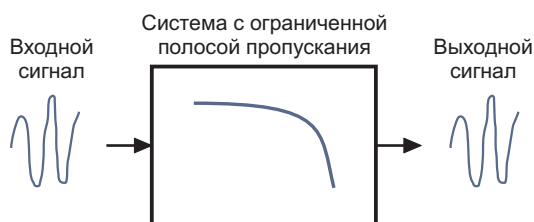
Рисунок 1. Хотя эта система имеет ограниченную полосу (фильтр нижних частот), ее достаточно для пропускания сигнала без искажений.
