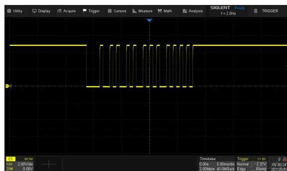
Рисунок 4. Выходной сигнал инфракрасного приемного модуля (U1).
