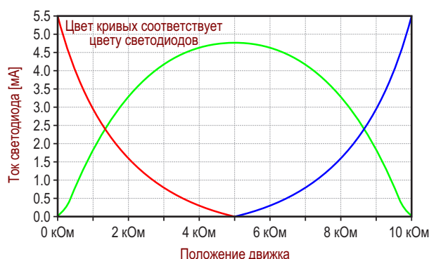
Рисунок 2. На этом графике показана зависимость тока светодиодов от угла поворота потенциометра.
