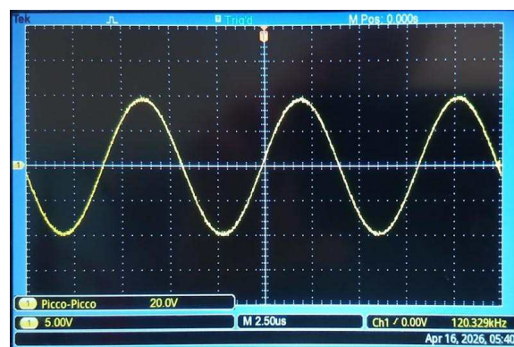
Рисунок 2. Сигнал, генерируемый схемой, очень близок к идеальной синусоиде.
