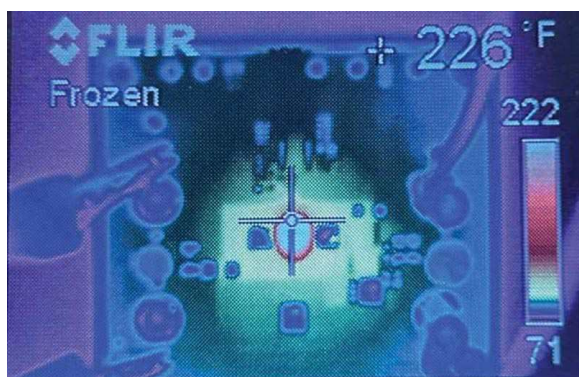
Рисунок 6. Перегрев насыщенного дросселя составляет 226 °F (107.78 °C).
