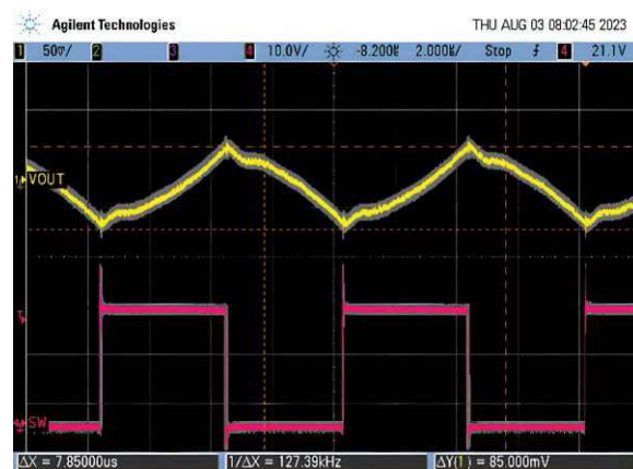
Рисунок 2. Дрожание, вызванное нестабильностью выходного сигнала. На осциллограмме, полученной при включенной функции послесвечения, показан выходной сигнал при недостаточном сопротивлении R_{\text{SENSE}} . Подсвеченная осциллограмма отображает сигнал при номинальном сопротивлении R_{\text{SENSE}} .
