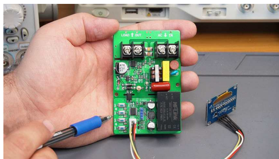
Рисунок 7. Печатная плата счетчика электроэнергии переменного тока в сборе.
