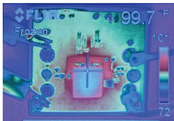
Рисунок 9. Номинальный перегрев дросселя составляет 99.7 °F (37.61 °C).
