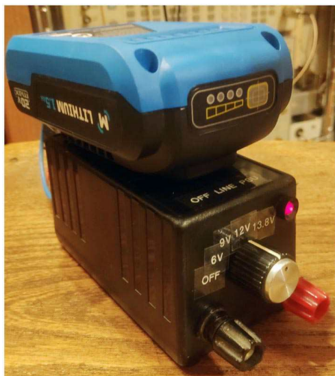
Рисунок 4. Фотография готового блока питания, четыре выходных напряжения которого можно выбирать с помощью ручки.
