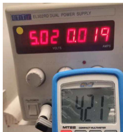
Рисунок 4. На фотографии показан ток, потребляемый схемой от лабораторного источника питания 5 В, а на снимке мультиметра — напряжение Li-ion аккумулятора 4.21 В после завершения зарядки.
