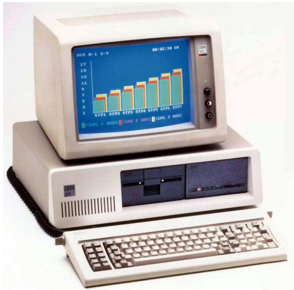
Рисунок 5. В IBM PC XT к двум дисководам для гибких дисков добавился жесткий диск.
