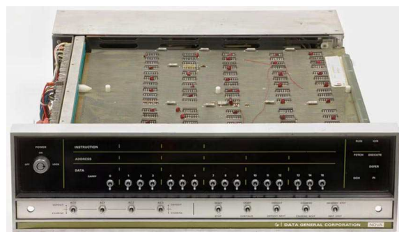
Рисунок 3. 16-разрядные мини-компьютеры серии Nova компании Data General. Они пользовались популярностью в научных лабораториях и инженерных подразделениях.
