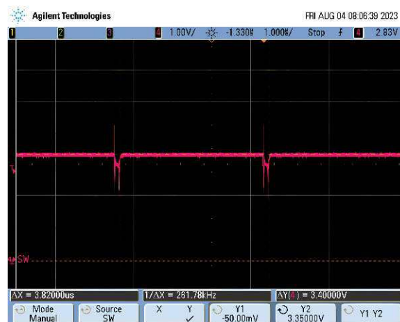
Рисунок 2. Коммутационный узел без вольтодобавочного конденсатора.
