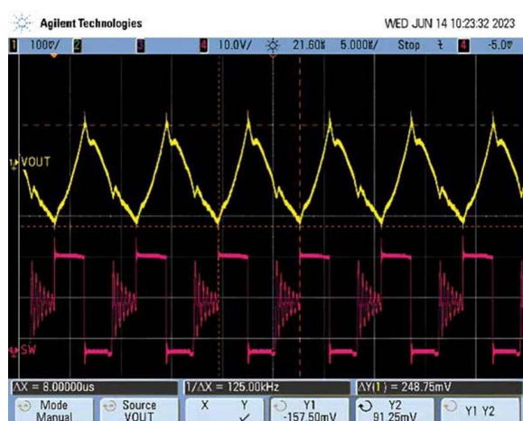
Рисунок 11. Форма тока дросселя при недостаточной индуктивности. Наличие звона на выходе и в коммутационном узле указывают на то, что источник питания работает в режиме DCM.
