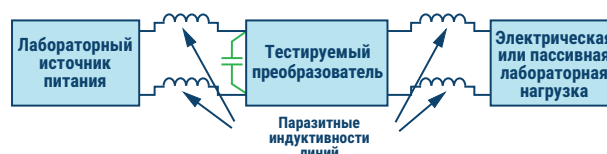
Рисунок 1. Подключения источника питания для проведения тестов.
