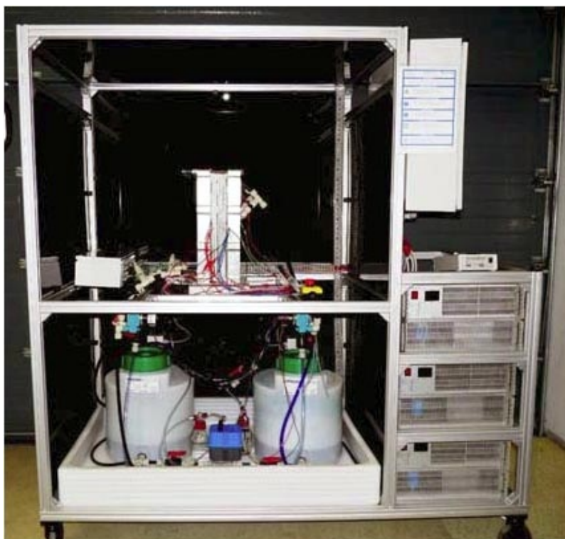
Лабораторная испытательная установка мощностью 1 кВт, предназначенная для оценки результатов моделирования
