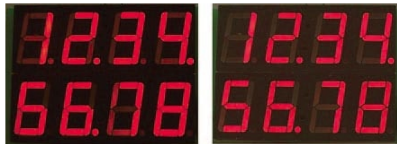
Рисунок 2. Без резисторов R_7 видно подсвечивание выключенных сегментов индикатора (слева). С резисторами R_7 такого эффекта не наблюдается, даже при нажатии кнопок S_1-S_3 .
