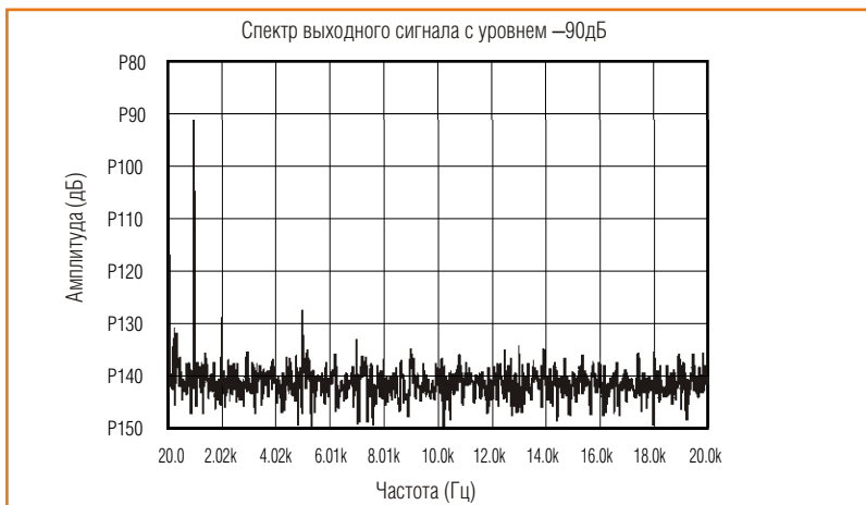
Рис. 11. Спектр выходного сигнала микросхемы PCM1704
