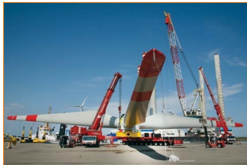
Двадцатиосные транспортеры Scheuerle перевозили полностью собранные роторы диаметром 116 и 118 метров и весом около 150 тонн.
