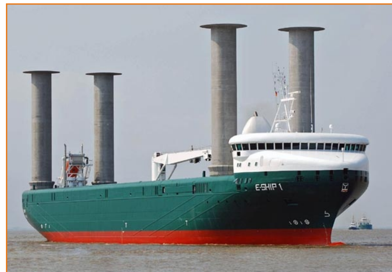
На палубе E-Ship 1 установлены четыре 27-метровых ротора Флеттнера.
