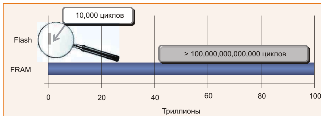
Рисунок 6. Сравнение ресурса записи Flash- и FRAM памяти.
