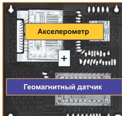
**Рисунок 5.** 3-осевой акселерометр и 3-осевой магнитометр LSM303DLH в компактном корпусе LGA.
