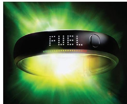
В шагомере высшего класса FuelBand компании Nike для подсчета количества шагов используется акселерометр, цветная линейка светодиодов обеспечивает постоянную обратную связь, а программное обеспечение взаимодействует с приложениями смартфона.
