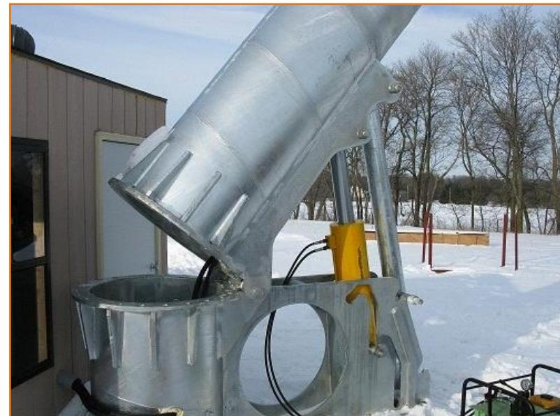
Башня с гидравлическим подъемником для турбин мощностью 20 кВт компании Hongkong Skywing Group
