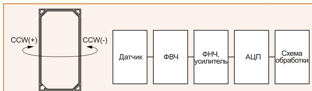
**Рисунок 7.** Схема включения датчика угловой скорости.
