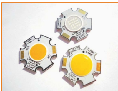
Рисунок 2б. 12-вольтовые AC-LED компании Lynk Labs в корпусах COB.
