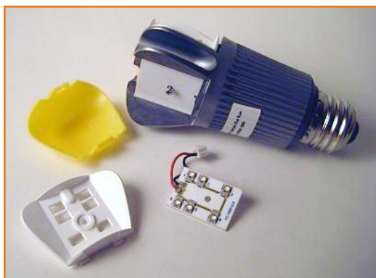
Рисунок 3. Лампа состоит из трех секций по шесть синих светодиодов в каждой.
