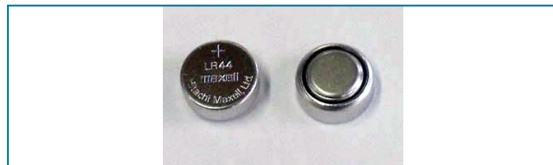
Рисунок 3. Типичная щелочная часовая батарейка LR44 имеет емкость 150 мА ч.
