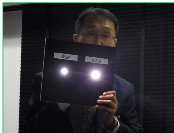
Белый светодиод на основе нового материала (слева) и традиционный белый светодиод (справа).
