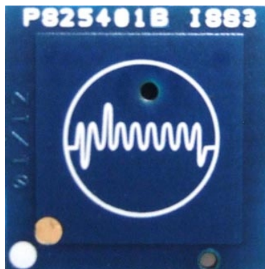
Рисунок 4. Бесконтактный твердотельный датчик электрического потенциала PS25401B компании Plessey Semiconductors в корпусе (слева) и со снятой крышкой (справа).
