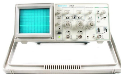
Рисунок 1. Двухканальный портативный осциллограф Tektronix 2205 с полосой 20 МГц.
