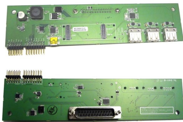
Рисунок 1. Плата TurtleCore вставляется в iRobot Create.
