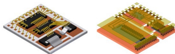
Сравнение технологий корпусирования: традиционная (слева), Blade (справа).
