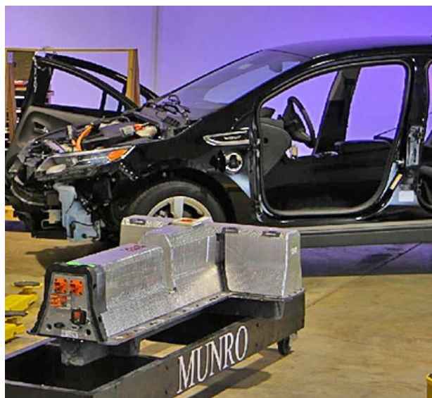
Рисунок 1. Литий-ионный аккумулятор весом 170 кг является сердцем Chevy Volt. Системы и программное обеспечение автомобиля нацелены на поддержание его жизнеспособности в течение максимально возможного времени.
