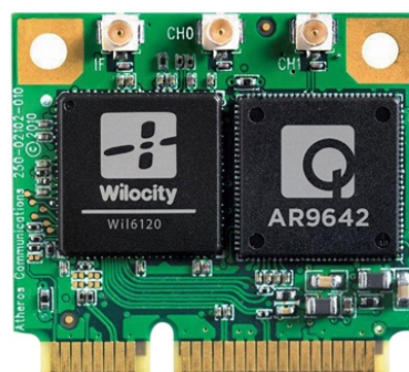
Рисунок 2. Сочетание микросхемы стандарта 802.11n компании Qualcomm Atheros и трансивера диапазона 60 ГГц компании Wilocity образует трехдиапазонный модуль, который может использоваться в горячих точках доступа, роутерах и других устройствах беспроводных сетей.
