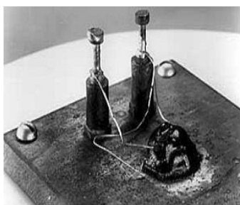
Первый плоскостной транзистор, созданный в Bell Labs.
