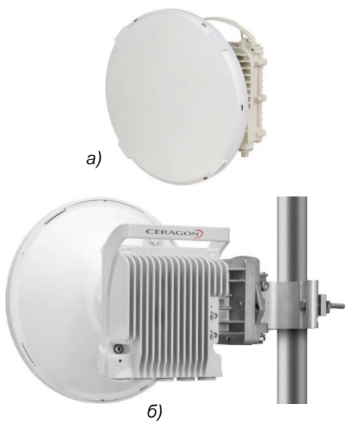
Рисунок 5. Транзитные блоки для малых сот очень компактны и монтируются на фонарных столбах или других объектах. Etherhaul 1200Т компании Siklu работает в Е-диапазоне от 71 до 76 ГГц и обеспечивает скорость передачи данных до 1 Гб/с (а). Модели IP-20С фирмы Ceragon работают в диапазоне от 6 до 38 ГГц (б). При использовании технологии MIMO скорость передачи данных может достигать 2 Гб/с
