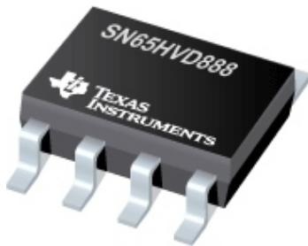
В микросхему интегрированы дифференциальный драйвер и дифференциальный приемник, которые работают от одного источника питания 5 В. Дифференциальные выходы драйвера и дифференциальные входы приемника имеют внутренние соединения, образующие порт шины RS-485 для реализации полуудуплексного (двухпроводного) обмена данными.
