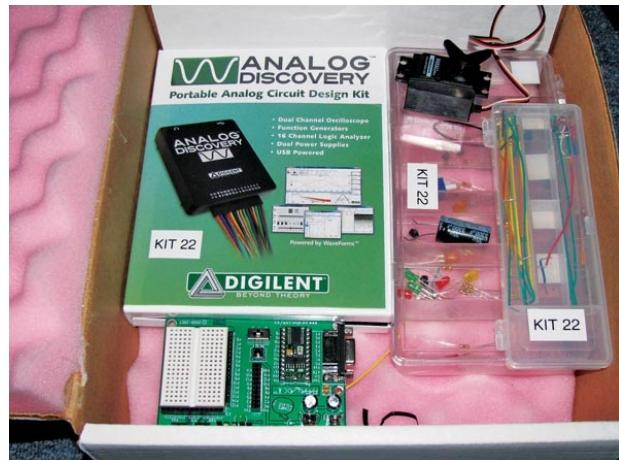
**Рисунок 2.** Комплект *Analog Discovery Design Kit* представляет собой реальный интерфейс ввода/вывода аналоговых и цифровых сигналов. В сочетании с ним компьютер, имеющий разъем *USB*, превращается в осциллограф, анализатор спектра, вольтметр и генератор сигналов синусоидальной формы.
