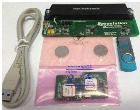
*Рисунок 4. Типовой проект активной RFID системы компании AMS.*
