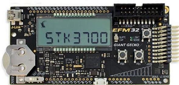
**Рисунок 2.** Стартовый набор EFM32 Giant Gecko Starter Kit.
