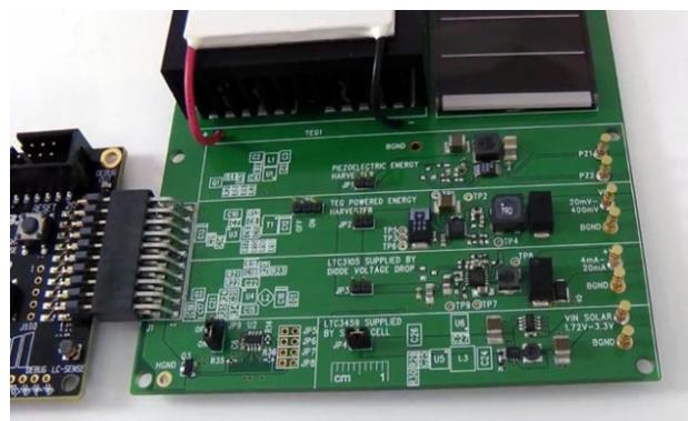
Рисунок 1. Многоцелевая плата сбора энергии компании Linear Technology.
