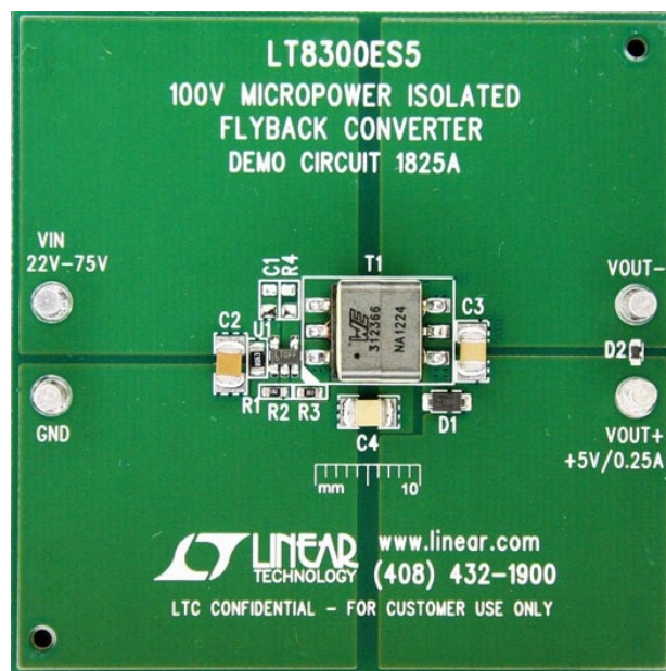
Рисунок 3. Демонстрационная плата преобразователя напряжения 22 ... 75 В в напряжение 5 В/0.3 А (См. Рисунок 1).
