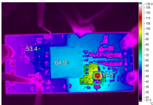
Рисунок 4. Тепловое изображение преобразователя 5 В/5 А с выходным диодом PDS760.
