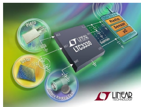
Рисунок 4. DC/DC преобразователь микросхемы сбора энергии LTC3330 продлевает срок жизни батареи, используя энергию пьезоэлектрических, солнечных или магнитных источников.
