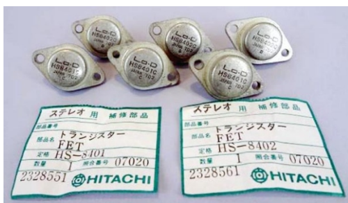
Рисунок 10. Ремкомплект транзисторов HS8401/02.
