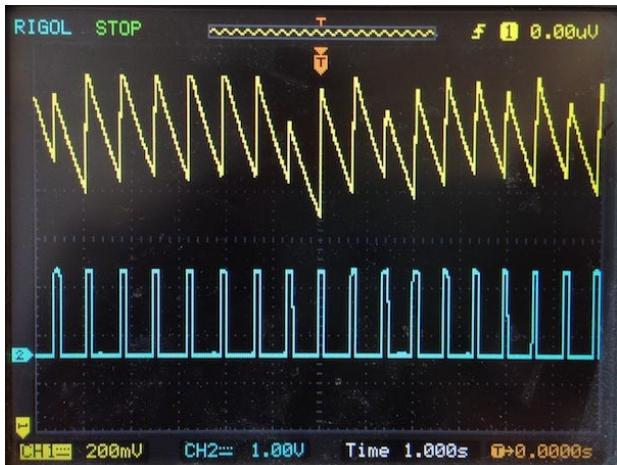
**Рисунок 2.** Временные диаграммы напряжений в точках COMP (Канал 1) и Pulse (Канал 2).
