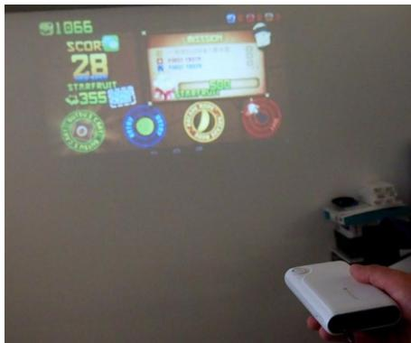
Небольшое устройство белого цвета, умещающееся в руке, работает с любым приложением Android, создавая на любой стене 80-дюймовое изображение формата 854 × 480 пикселей. При световом потоке 150 лм проектор может осветить любую комнату. К устройству прилагается специальный стилус.
