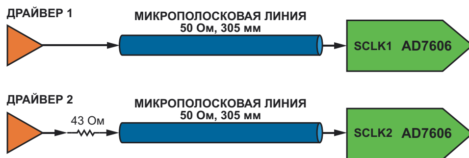
Рисунок 8. Передача импульсов SCLK в АЦП AD7606.
