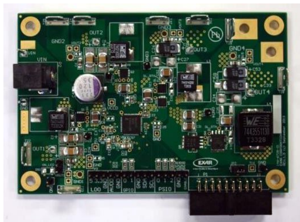
Оценочная плата XR77128EVB с Arduino-совместимыми портами GPIO, PSIO и ENABLE.
