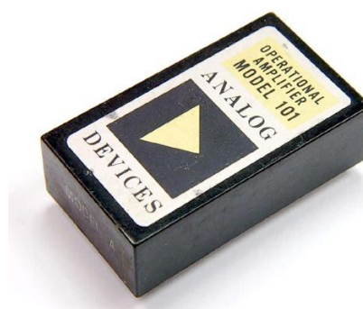
Рисунок 9. Первый модульный ОУ ADI Model 101.
