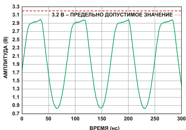
Рисунок 11. Несимметричный вход АЦП с напряжением, ограниченным с помощью диодов Шоттки.
