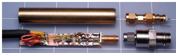
Рисунок 3. Пробник можно собрать на кусочке макетной платы, уместяющемся в отрезке медной трубки. К входному разъему SMA выпускается множество адаптеров, несколько из которых показано на фотографии. Со стороны выхода торец трубки закройте резиновой втулкой.
