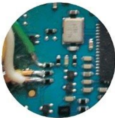
Рисунок 4. Места припайки проводов для подключения светодиодов (справа); то же в увеличенном виде (слева).
