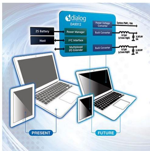
При использовании DA9312 требуется лишь несколько внешних компонентов, занимающих на печатной плате всего  $80\text{ mm}^2$  – совсем небольшую часть от площади, которая требуется преобразователям мощности на дискретных компонентах. Устройство имеет лучший в отрасли КПД в 98%, минимизируя проблемы отвода тепла и повышая надежность конечного продукта.
