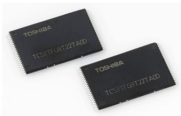
BiCS FLASH основана на новейшем процессе производства 48-слойных структур, позволяющем создавать память больших объемов, с большим количеством циклов
