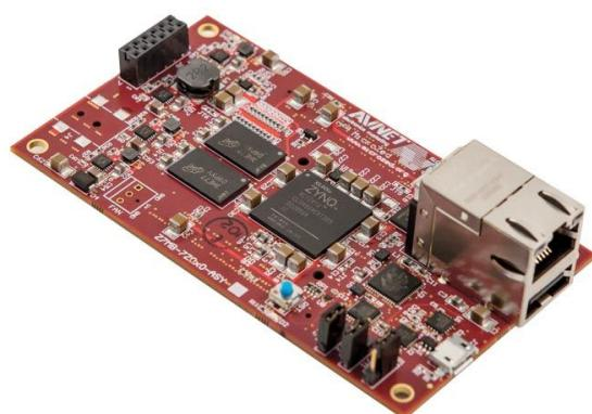
даже предоставляет микроконтроллеру возможность управлять шинами питания MicroZed. Это позволяет использовать такие решения, когда потребляемая мощность может быть снижена за счет выгрузки задач в микроконтроллер, в то время как ресурсы СнМ MicroZed резервируются для выполнения функций, требующих специальных средств обработки.
