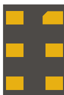
Образец A MicroPak 6 контактов безвыводной (шаг выводов 0.5 мм) Площадь контакта одного вывода: 0.065 мм 2 Общая площадь контакта: 0.39 мм 2
