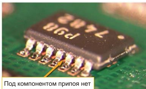
Паяльная паста, нанесенная на контактные площадки безвыводных корпусов на универсальном посадочном месте.
