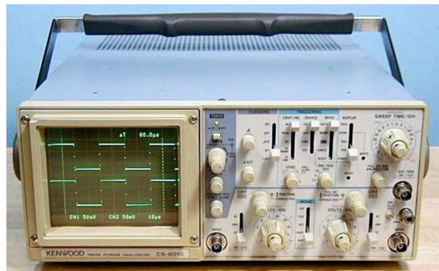
**Рисунок 8.** Запоминающий цифровой осциллограф CS-8010.
