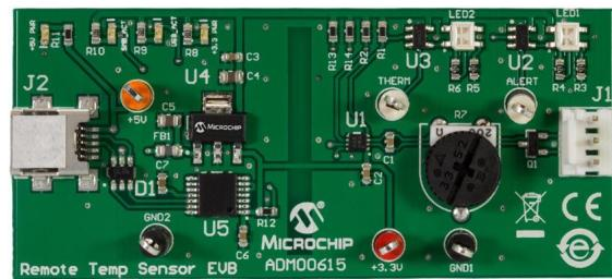
Оценочная плата ADM00615 выносного измерителя температуры на основе MCP9902.
