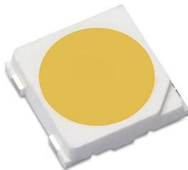
Максимальную гибкость разработки обеспечивают четыре градации характеристик приборов линейки LUXEON 3535L: светодиоды начального уровня (LUXEON 3535LS), стандартные (LUXEON 3535L) и высокоэффективные (LUXEON 3535L HE, HE Plus).
