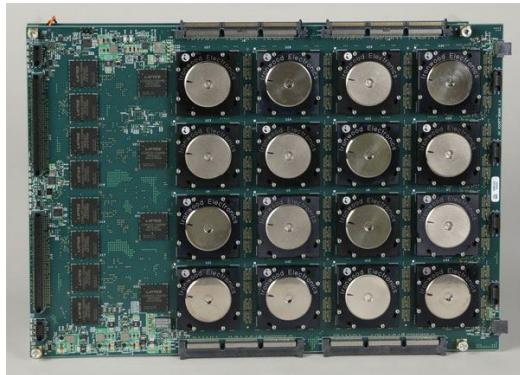
Синаптическая плата с 16 микросхемами.
