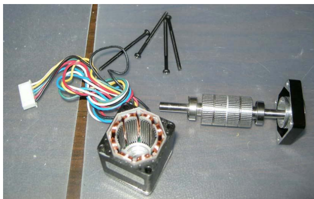
Рисунок 2. Типовая конструкция гибридного шагового двигателя.
