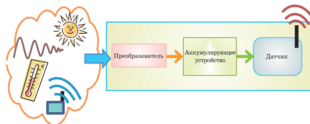
Рис. 1. Типовая структура беспроводного датчика с использованием энергособирающего устройства
