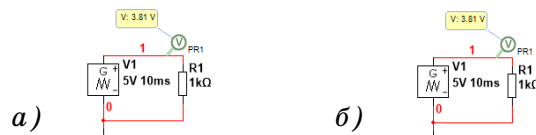
Рис. 4. Результаты измерения напряжения на выходе генератора треугольных импульсов пробником напряжения в режиме "Instantaneous" (а) и в режиме "Instantaneous and periodic" (б)
