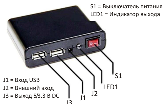
Рисунок 3. Возможный вариант конструкции корпуса для универсального источника питания устройств на микроконтроллерах.
