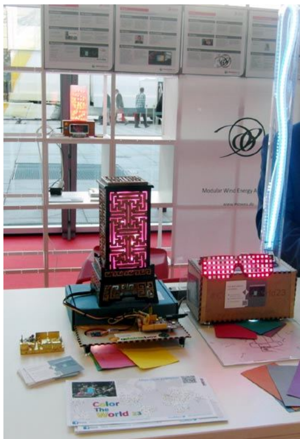
Рисунок 11. «Магическая лампа» Jean Noel Lefebvre (Франция), окраска которой изменяется в соответствии с цветом цветной бумаги, подложенной под предметный столик прибора. Справа на ящичке дырчатые очки того же автора с автономным источником питания, которые могут отображать бегущую строку с информацией.
