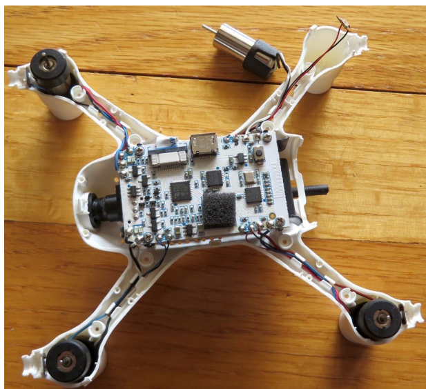
Рисунок 1. Дрон со снятой крышкой. Как и следовало ожидать, обычные коллекторные двигатели. Антенна видеопередатчика торчит из задней части беспилотника (на фото справа).
