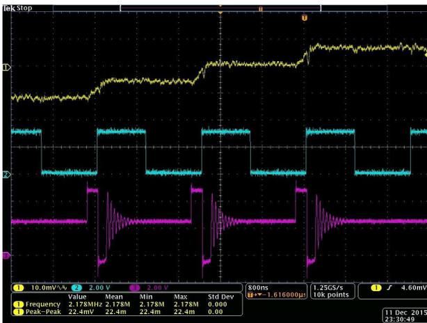
**Рисунок 8.** Пульсации переключения микросхемы ADP5300 (желтый цвет) при использовании функции STOP и частоте преобразования 500 квыб/с; сигнал CNV/STOP (синий) и вывод SW (розовый).
