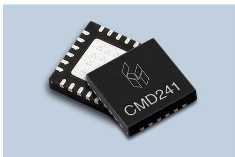
Коэффициент усиления CMD241P4 превышает 13 дБ при коэффициенте шума 2.3 дБ. Как коэффициент усиления, так и коэффициент шума усилителя исключительно стабильны во всем диапазоне рабочих температур от -55 °С до +85 °С. Точка децибелной компрессии CMD241P4 на частоте 11 ГГц расположена выше +21 дБм, а выход-
