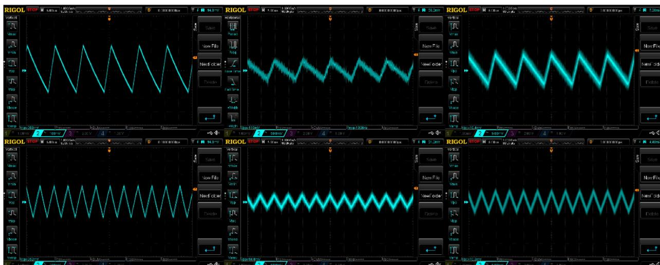
**Рисунок 2.** Верхние осциллограммы – обычный ШИМ. Нижние осциллограммы – сигнал сдвоенного ШИМ со смещением фазы. Чувствительность (В/дел) уменьшается слева направо: 100 мВ, 50 мВ, 5 мВ.
