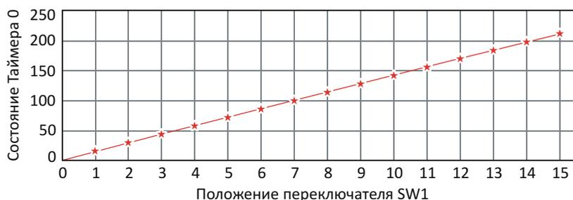
**Рисунок 3.** Состояния счетчика на момент прерываний при 16 положениях переключателя SW1 показывают хорошую линейность результата.
