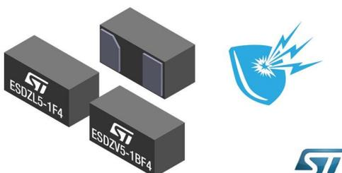
Однонаправленные приборы ESDZL5-1F4 и двунаправленные ESDZV5-1BF4 с отпирающим напряжением 5.8 В и низким динамическим сопротивлением выпускаются в корпусах с типовыми размерами всего 0.58 мм × 0.28 мм. Равная 6 пФ емкость позволяет использовать супрессоры для поддержания целостности высокоскоростных сигналов. Устройства устойчивы к контактным электростатическим разрядам 15 кВ и 18 кВ, соответственно, превосходя требования спецификаций стандарта 61000-4-2.
