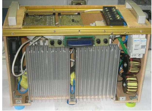
**Рисунок 8.** Конструкция импульсного стабилизатора напряжения мощностью 9 кВА.
