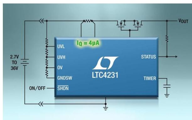
**Рисунок 2.** Контроллер горячей замены и разъединитель нагрузки LTC4231, потребляющий всего 4 мкА, идеален для систем с батарейным питанием.
