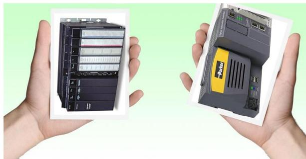
Наиболее заметное различие между ПЛК и ПКА заключается в их программных интерфейсах. ПКА более сложны, и программируются на Си или Си++. Напротив, ПЛК программируются с применением диаграмм лестничной логики – языка программирования, в котором используются символы, представляющие релейные электрические схемы. Эти различия в способах программирования определяют различия в архитектуре и возможностях двух типов компьютеров.
