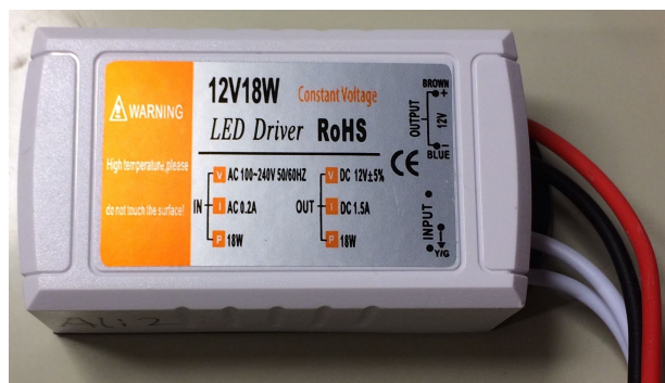
Рисунок 1. Блок питания 12 В/18 Вт. Обратите внимание на КПД, равный 100% (входная и выходная мощность по 18 Вт), и на страшное предупреждение не касаться поверхности пластикового корпуса из-за высокой температуры!
