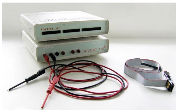
Рисунок 6. Сигнатурный анализатор SFL1500.
