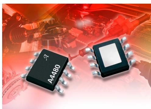
Микросхема A4480 содержит уникальный многорежимный предварительный регулятор на основе зарядового насоса с последующим 5-вольтовым LDO стабилизатором. Это позволяет поддерживать стабильное выходное напряжение 5 В в широком диапазоне входных напряжений от 3.5 В до 28 В с порогом защиты 40 В. По сравнению с обычными
