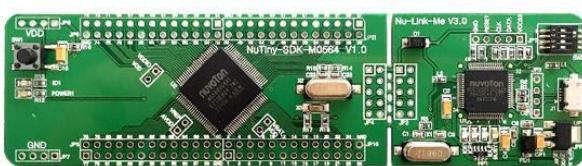
Отладочная плата NT-M0564V.
