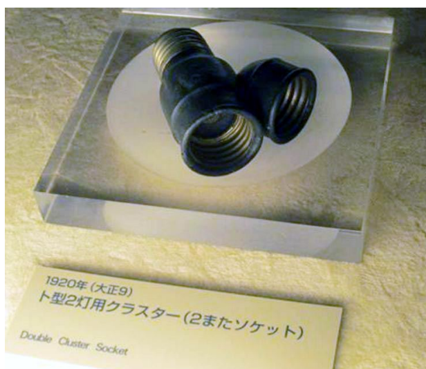
Рисунок 4. Ответвитель для подключения двух ламп к одному патрону.
