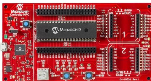
Отладочная плата Curiosity High Pin Count (DM164136).
