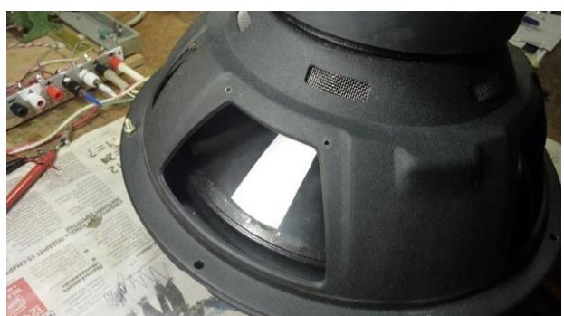
**Рисунок 17.** Вид рефлектора, укрепленного на диффузоре громкоговорителя.
