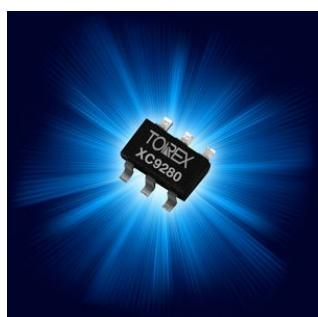
Рассчитанная на входные напряжения до 18 В и токи нагрузки до 3 А микросхема XC9280 работает на постоянной частоте переключения 1.2 МГц, позволяющей использовать дроссели небольшой индуктивности (2.2 мкГн). Прибор выпускается в компактном корпусе TSOT-26 с размерами 2.8 мм × 2.9 мм × 1.1 мм.
