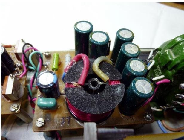
**Рисунок 7.** Внешний вид блока питания на +1.5 В.
