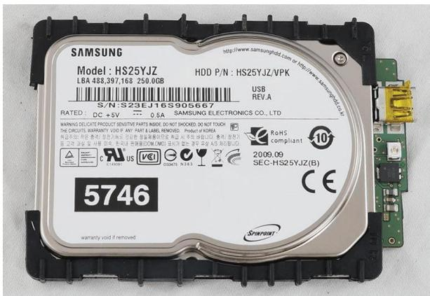
**Рисунок 3.** Резиновые ударопоглотители амортизируют привод внутри его пластикового корпуса.
