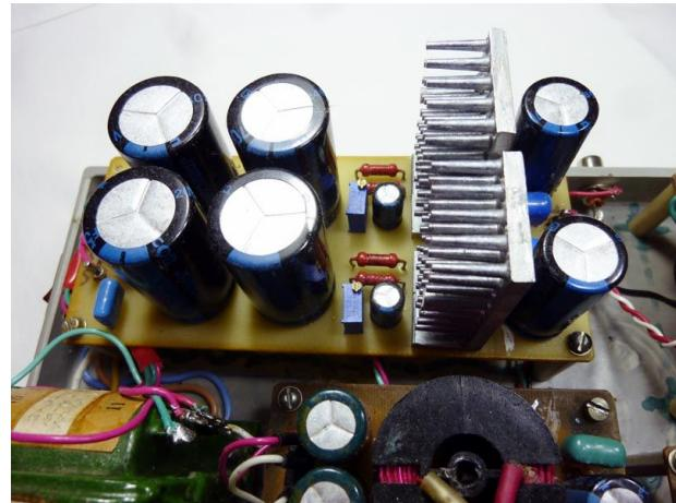
**Рисунок 4.** Вид панели питания  $\pm 27$  В для датчика съема смещения.
