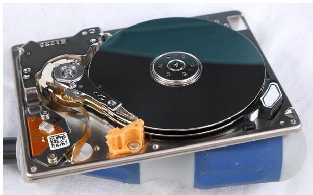
**Рисунок 1.** Во внешнем накопителе Samsung 1.8" емкость 250 ГБ обеспечивается двумя «блинами».
