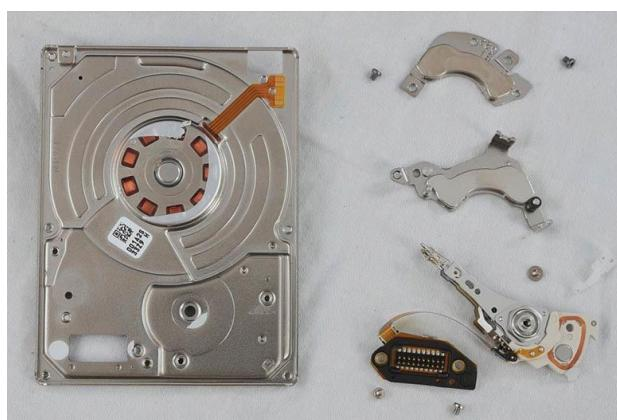
**Рисунок 8.** В корпусе смонтированы двигатель шпинделя и сборка плавающих головок с магнитами, а также разъем для сервопривода коромысла и сигнальных линий.
