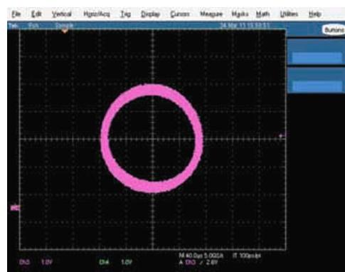
**Рисунок 3.** При перестройке частоты сдвиг фаз меняется от  $-89^\circ$  до  $-91^\circ$ .
