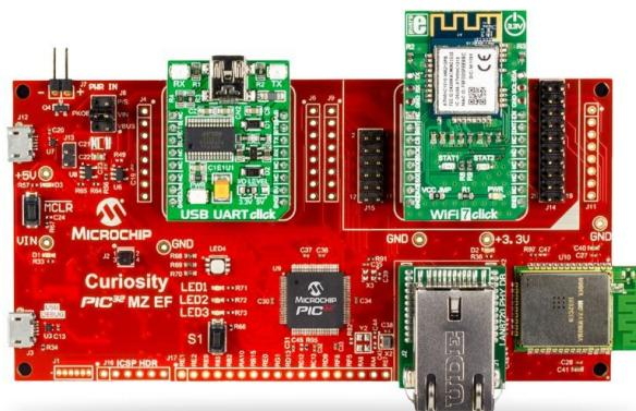
**Рисунок 1.** Отладочная плата Microchip Curiosity PIC32MZEF с установленными платами расширения для разработки приложений IoT.
