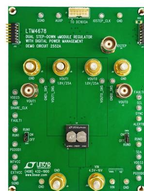
Демонстрационный модуль 2552A – два 25-амперных или один 50-амперный регулятор с цифровым управлением.
