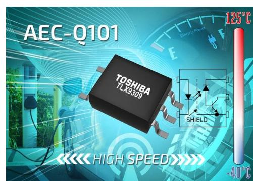
TLX9309 выпускается в 5-выводном корпусе SO6 с размерами 3.7 мм × 7.0 мм × 2.2 мм и рассчитан на работу в диапазоне температур от -40 °C до +125 °C. Оптоизолятор, отвечающий требованиям директивы RoHS и стандарта AEC-Q101, может использоваться в автомобильных приложениях.
