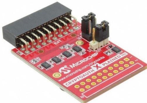
**Рисунок 4.** На универсальной оценочной плате ATCryptoAuth-XPRO-B установлено несколько различных сопроцессоров шифрования.
