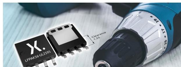
PSMN0R9-30ULD и PSMN1R0-40ULD выпускаются в улучшенных корпусах SOT1023A с длинами путей утечки по корпусу и между выводами, равными 1.5 мм и 1.55 мм, соответственно. Транзистор PSMN0R9-30ULD рассчитан на напряжение 30 В, имеет сопротивление канала 0.87 мОм и способен пропускать ток до 300 А, тогда как для PSMN1R0-40ULD эти параметры равны 40 В, 1.1 мОм и 280 А, соответственно.
