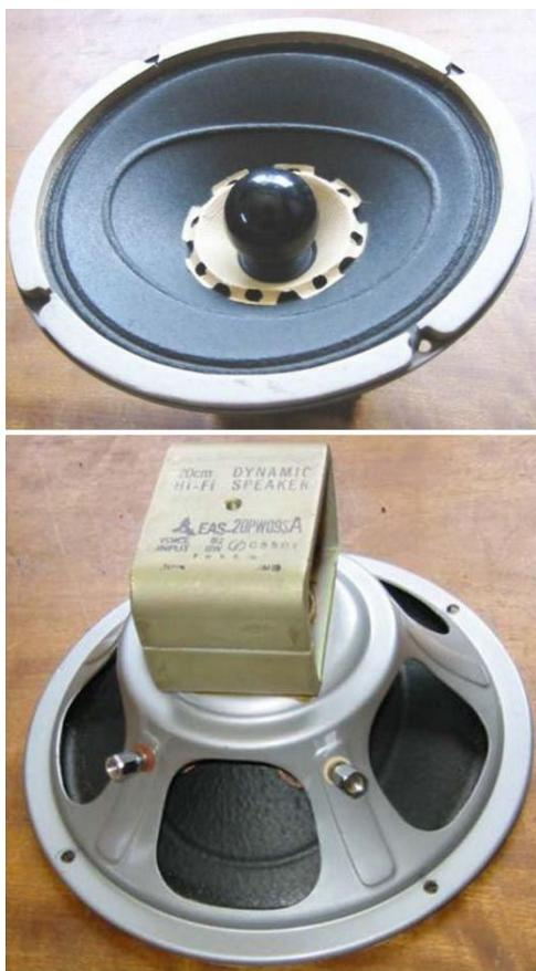
**Рисунок 4.** Одна из модификаций динамической головки National EAS-20PW09.
