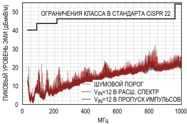
Рисунок 6. Сравнение измеренных характеристик ЭМИ преобразователя 12 В/3.3 В с выходным током 1.2 А с требованиями Клас-са В стандарта CISPR 22. (Трехметровая вертикальная антенна; без фильтра ЭМИ).
