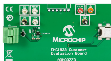
Оценочная плата выносного датчика температуры на микросхеме EMC1833 (ADM00773).
