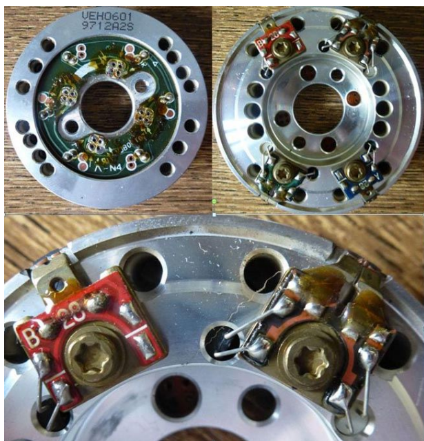
Рисунок 4. Расположение видео и звуковых Hi-Fi головок БВГ VEN0601.
