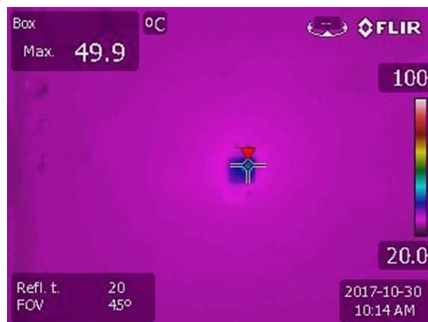
Рисунок 2. Преобразователь 12 В/5 В на основе LTM8074 с полной нагрузкой 1 А при комнатной температуре (23 °С) работает с незначительным перегревом.
