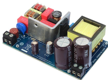
35-ваттный обратноходовой преобразователь с широким диапазоном входных напряжений на основе квазирезонансного контроллера HVLED001B и 800-вольтового MOSFET STF10LN80K5.
