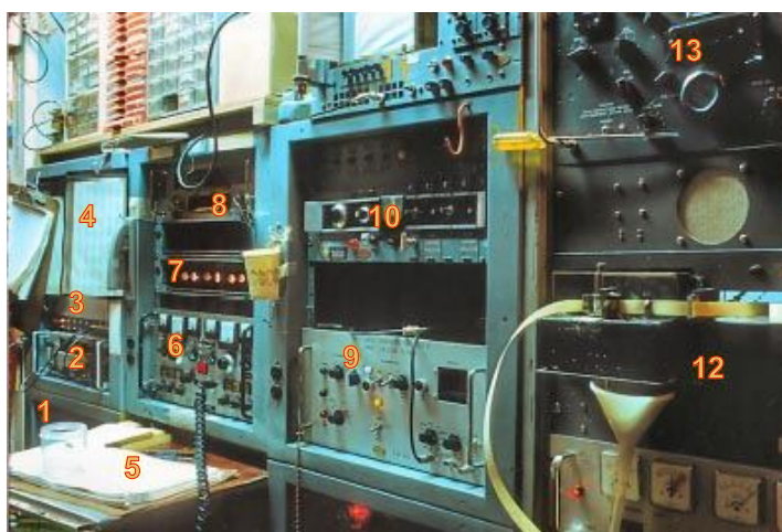
Рисунок 3. Навигационный приемник сигналов НСС Transit и оборудование наземной станции слежения. 2 – таймер-счетчик, 6 – приемник слежения за сигналами спутников, 9 – блок оцифровки и тактовых сигналов, 10 – мастер-генератор тактовых сигналов, 12 – перфоратор бумажной ленты регистратора сигналов, 13 – коротковолновый приемник.
