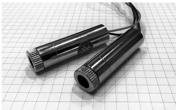
Рисунок 2. Инфракрасные лазеры мощностью 30 мВт с длиной волны 980 нм.
