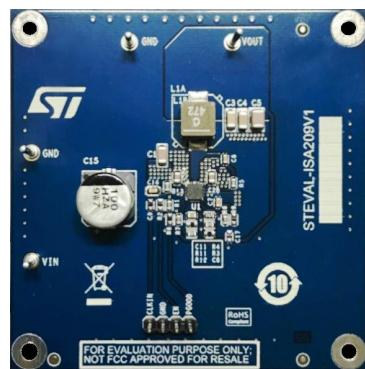
Оценочная плата понижающего преобразователя на основе микросхемы L6983NQTR с выходным током 3 А и входным напряжением 38 В.
