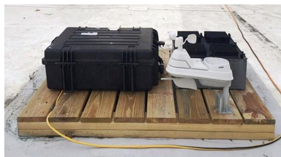
**Рисунок 1.** Метеостанция с тепловым резонатором, разработанная коллективом из MIT [3].
