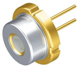
С точки зрения яркости, лазерные диоды имеют определенные преимущества перед светодиодами. При рабочем токе 2 А оптическая мощность PLPT9\_450LA\_E достигает 3.0 Вт, а длина волны излучаемого синего света составляет 447 нм. В типичной оптической системе лазерное излучение фокусируется в точке диаметром всего несколько микрометров. Лазер может использоваться непосредственно в качестве источника сине-
