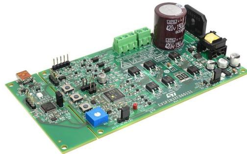
EVSPIN32F0601S1 – оценочная плата трехфазного инвертора на основе STSPIN32F0601.
