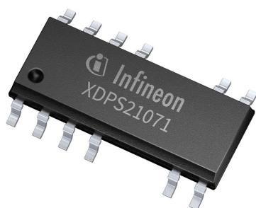
XDPS21071 содержит высокоэффективный цифровой контроллер обратноходового преобразователя с интегрированным драйвером сдвоенного MOSFET и 600-вольтовой цепью запуска на обедненном МОП-транзисторе. Контроллер первичной стороны управляет внешним высоковольтным MOSFET обратноходовой схемы и внешним низковольтным MOSFET, формирующими импульсы, обеспечивающие условия ZVS для высоковольтного MOSFET. Устройство поддерживает фиксированную частоту переключения до 140 кГц.
