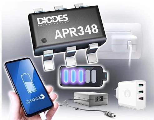
Драйвер APR348 способен управлять внешним MOSFET в конфигурации синхронного выпрямителя вторичной стороны как в верхнем, так и в нижнем плече. Гибкое и эффективное устройство поддерживает напряжения вторичной стороны до 20 В в режимах непрерывной проводимости (CCM), прерывистой проводимости и в квазирезонансном обратноходовом режиме. Эти опции предоставляют командам разработчиков полную свободу выбора схемы синхронного выпрямления.
