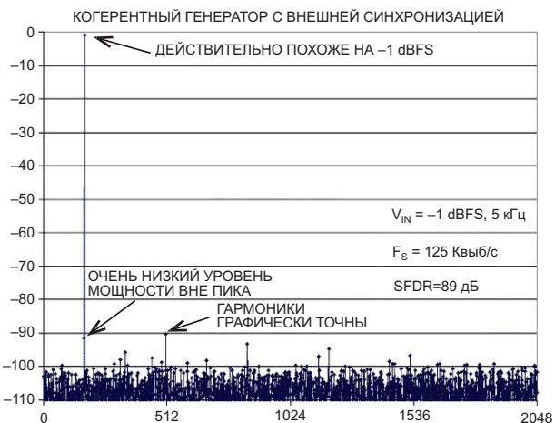
**Рисунок 5.** Более точное БПФ получено с использованием той же схемы генератора с мостом Вина, но синхронизируемой внешней частотой 5.157 кГц, подаваемой на «НОВЫЙ ВХОД» через резистор 200 кОм от генератора HP33250A. Заметьте, что теперь пик выглядит явно правдоподобно ( $-1 \text{ dBFS}$ ), и что мощности в частотных интервалах возле пика почти нет.
