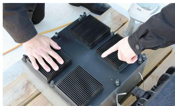
**Рисунок 2.** Термовой резонатор заполнен материалом, аккумулирующим тепло. Он генерирует электричество из температурных колебаний окружающей среды, возникающих в течение суток. (Источник: Melanie Gonick).
