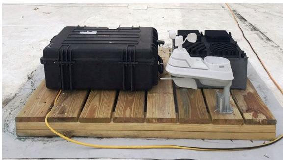
**Рисунок 3.** Метеостанция с тепловым резонатором, расположенная на крыше здания MIT, вырабатывает энергию при колебаниях температуры. (Источник: Justin Raymond).
